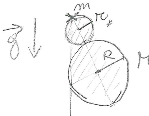
4) Uno yo-yo è costituito da un corpo sferico di massa  $M$  e raggio  $R$ , con una sottile scanalatura che determina una giunzione di raggio  $r$ , come in figura. Esso è posto su un piano e, trainato da una forza  $F$ , si muove di moto di puro rotolamento.
