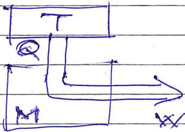
Impossibile realizzare una ~~macchina termica~~ ~~che compie un lavoro~~ <sup>trasformazione</sup> il cui unico effetto è la trasformazione <sup>Conversione</sup> integrabile in  $W$  del calore  $Q$  sottratto ad un unica sorgente a Temp costante
