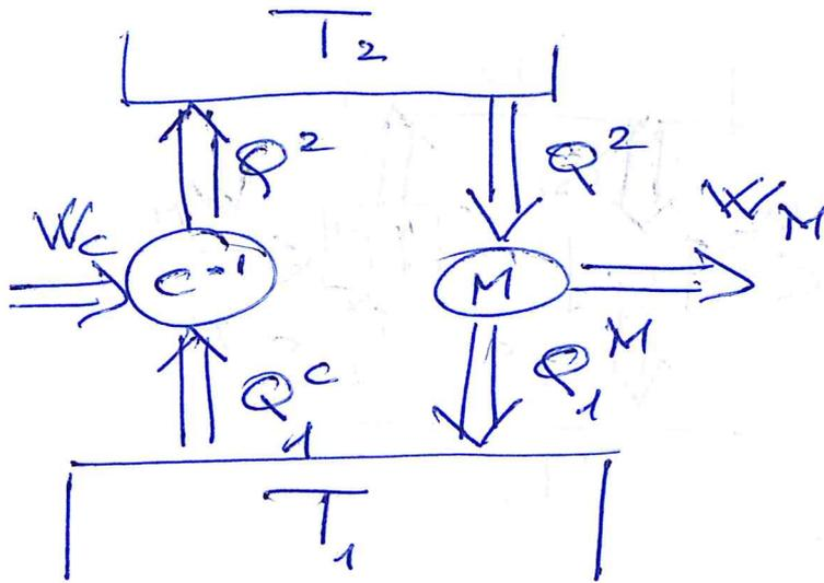
Questo ciclo termodinamico è monotermo non si ha nessun calore netto scambiato con  $T_2$ .
