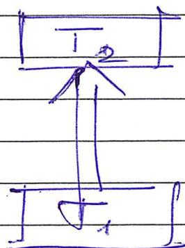
Impossibile realizzare una trasformazione il cui unico risultato sia il trasferimento di  $\dot{Q}$  da una sorgente a  $T_1$  ad una a  $T_2$  con temp  $T_2 > T_1$
