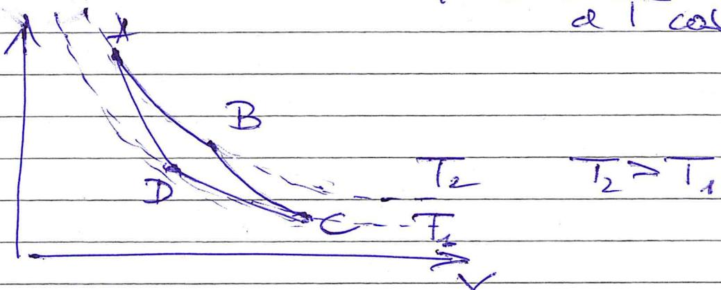
$T_{AB}$  = espansione isotermica a  $T_2$
