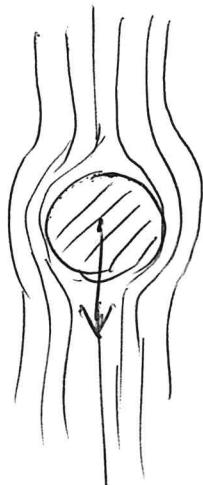
Moto di caduta di un corpo in un fluido, equivalente allo scorrimento del fluido attorno al corpo  $\rightarrow$  Fenomeno descritto dallo parametero  $\gamma$
