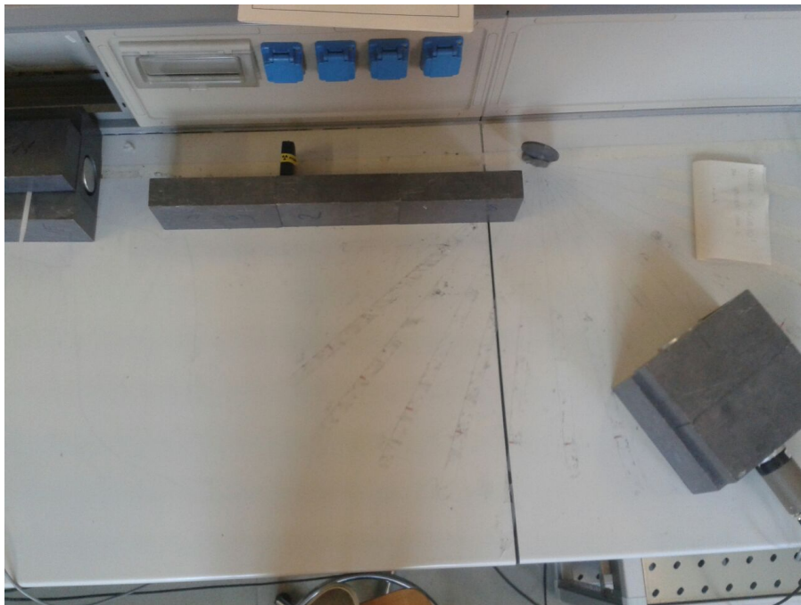
Figura 8.2: Schermature utilizzate per la misura della formula di Compton e della Klein-Nishina.
