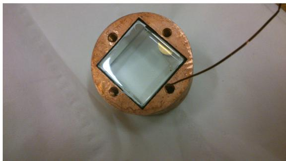
Figura 1.4: Cristallo 2cmx2cmx2cm di BGO assemblato per il montaggio nel criostato.
