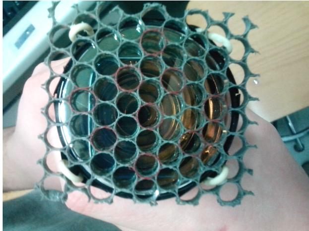
Figura 2.3: Fotocatodo con griglia per la mappatura. Contornati in rosso i punti utilizzati.
