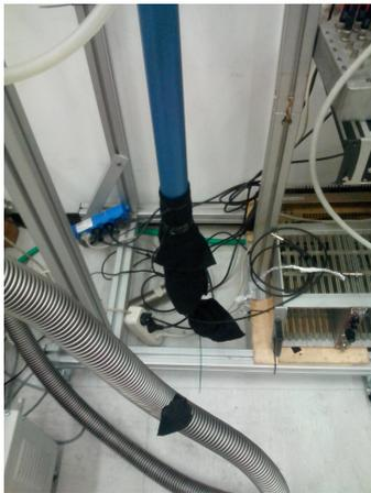
Figura 3.1: PMT collegato al criostato e schermato.
