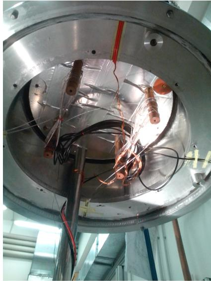
Figura 2.7: Foto del criostato aperto.
