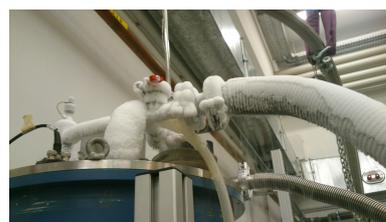
(c) Dettaglio del raccordo col criostato.
