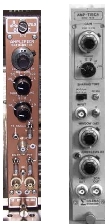
Figura (2.10). Immagine del modulo di amplificazione, a sinistra, e del modulo TiSCA, a destra.
