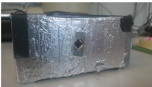
Figura A.5: La schermatura ha un'apertura sulla parte attiva del SiPD.
