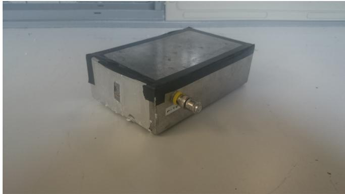
Figura A.6: Immagine del SiPD con evidenza del tappo da  $50\Omega$  che chiude l'ingresso di test del preamplificatore
