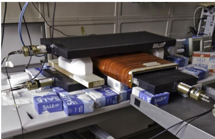
Figure 4.3: Foto dell'apparato sperimentale per la misura di asimmetria. La superficie efficace per la formazione del trigger è immersa nella regione di massima uniformità del campo magnetico, pur essendo notevolmente ridotta a causa della disposizione geometrica.
