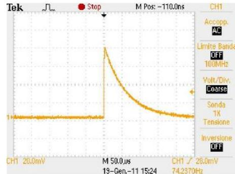
**Figura 3.3:** Segnale in uscita dal preamplificatore
