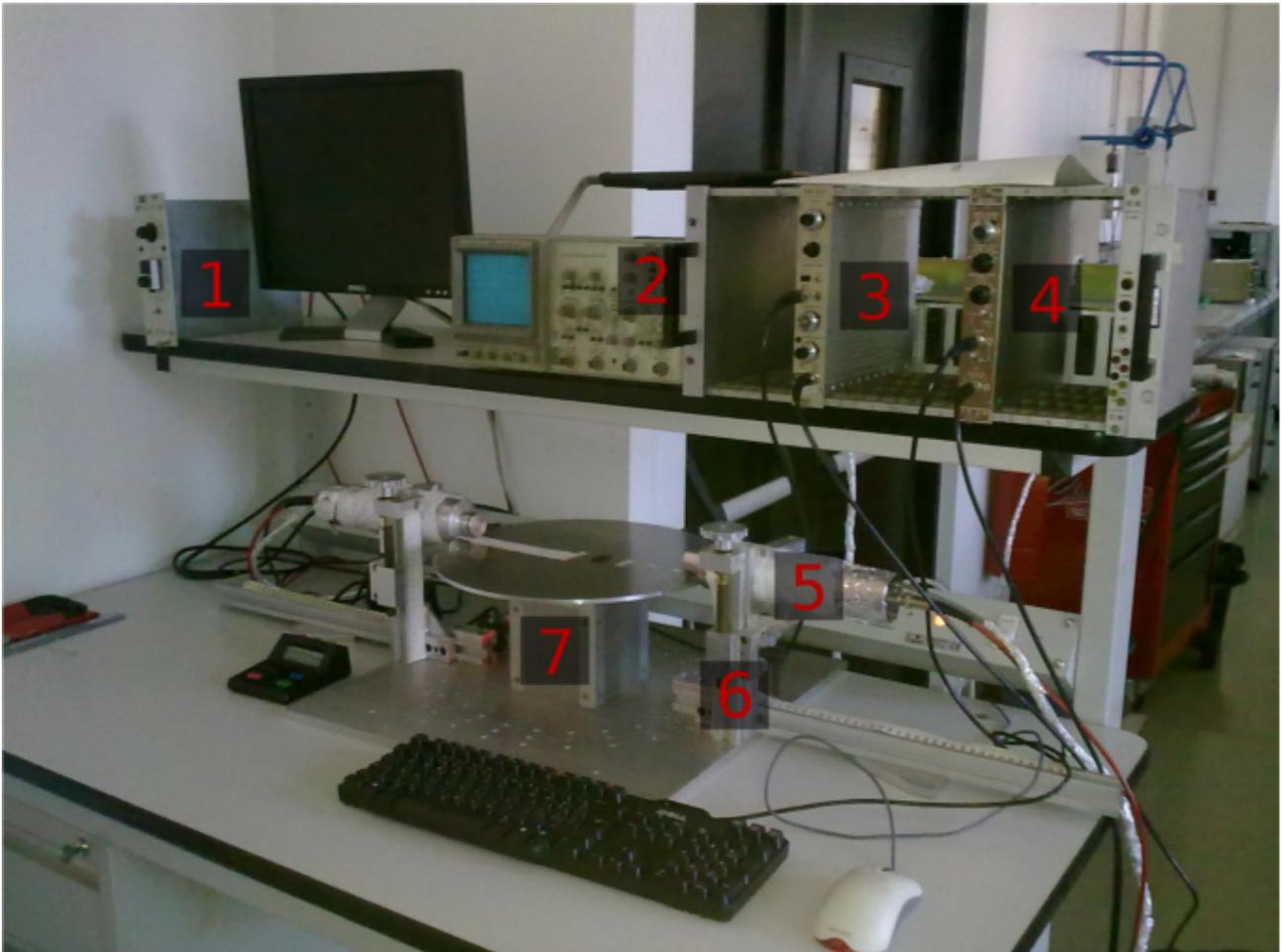
**Figura 2.1:** Apparato strumentale utilizzato. 1) Alimentatore; 2) Oscilloscopio 3) Amplificatore *TISCA 7616*; 4) Amplificatore *ORTEC 570*; 5) Scintillatore, PMT e preamplificatore; 6) Supporto mobile per i rivelatori; 7) Disco rotante.
